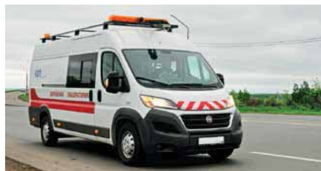
Рис. 6 Передвижная аэродромно-дорожная лаборатория: комплекс измерительный КП-514 СМП-07
