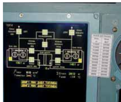
Рис. 2 Пульт ПКУ-50-1 системы управления и измерения топлива СУИТ-148 в кабине экипажа самолёта Ан-148-100
