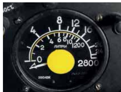
Рис. 1 Указатель топливомера СКЭС-2027Б в кабине экипажа вертолёта Ми-8МТ
