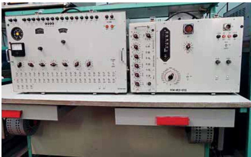
Рис. 4 Контрольно-проверочная аппаратура ёмкостных топливомеров КПА-ИС-2
