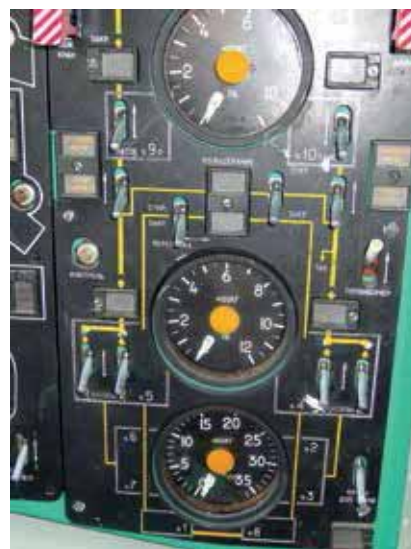
Рис. 3 Указатель системы СУИТ-5-2 в кабине экипажа вертолёта Ми-26Т
