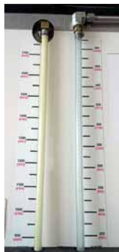
Рис. 6 Шкалы объемов на мерных расходных баках дейсеров для ПОЖ типов I и IV
